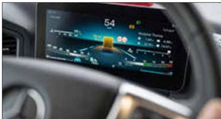
activarlo. Cuando la cámara del sistema detecta marcas de carril en ambos lados de la carretera, Active Drive Assist comienza a apoyar al conductor con una guía longitudinal y lateral, lo que se indica al conductor en la pantalla central de la cabina multimedia.
