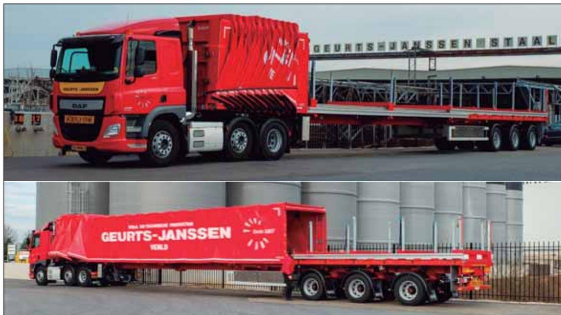
El proveedor Netcap ofrece un sistema deslizante para las lonas de los remolques. La construcción es extremadamente estable y la lona se abre y se cierra deslizando con suavidad.
