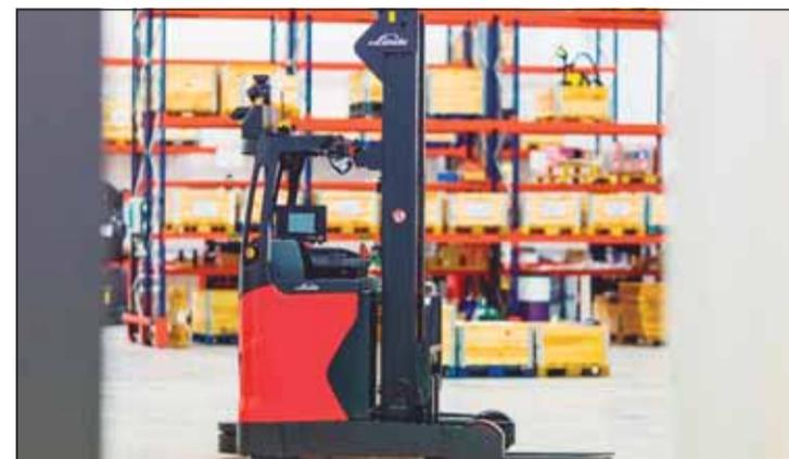
talar ningún elemento extra en el entorno. El láser de navegación escanea permanentemente el área en un radio de 360° para orientarse en el espacio. Durante este proceso, la R-Matic se mueve a una velocidad de hasta 2,5 metros por segundo.
