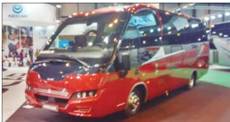
partiendo de un bastidor con motorización DAF y bajo un nuevo concepto basado en la entrega de los componentes de la zona de conductor en CKD, para una mejor adaptación e integración de esta zona a la carrocería.
