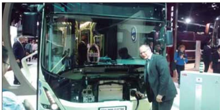
transporte una mayor flexibilidad. La duración de las baterías en particular, ha sido extendida significativamente en comparación con el modelo anterior. El nuevo Volvo 7900 Eléctrico está disponible con 150, 200 y 250 kWh. Esto significa que el autobús puede circular durante más tiempo entre carga y carga, permitiéndole ser utilizado de manera más eficiente durante toda la jornada.
