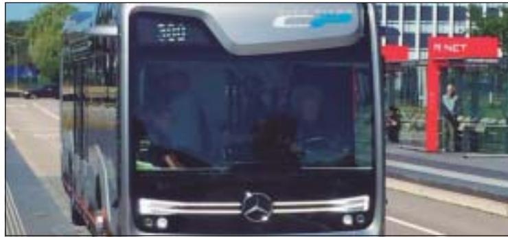
nocer obstáculos (especialmente peatones en la calzada) y frenar con autonomía cuando es necesario. Del mismo modo se aproxima automáticamente a las paradas, y abre y cierra las puertas una vez detenido. Por último, es capaz de circular por túneles.
