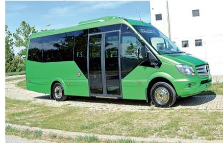
**Chasis:** Sobre chasis-cabina extralargo Mercedes-Benz Sprinter.
