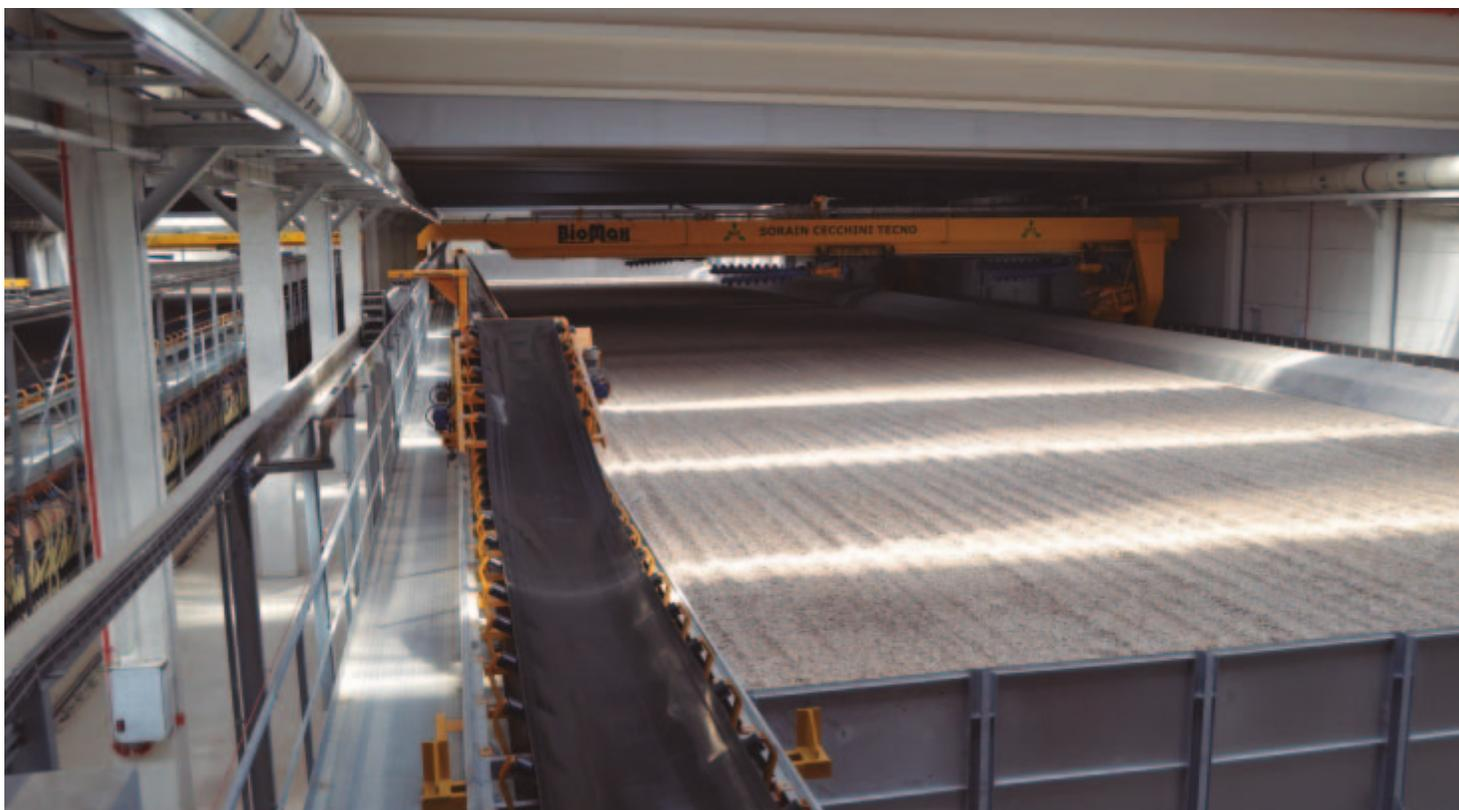
los que avanzan los restos de las ramas y troncos arrastrados por el giro de los rodillos. Como consecuencia de este movimiento, el material es desgarrado y troceado en el sentido de las fibras de madera.
