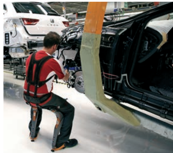
UN TRABAJADOR DE SEAT DE LA CADENA DE MONTAJE ENFUNDADO EN UN EXOESQUELETO | SEAT
