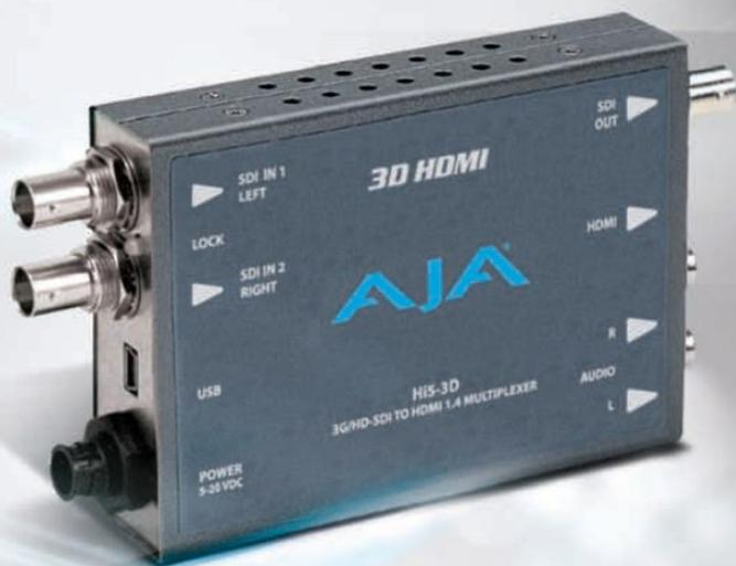
Como nuevo miembro de nuestra gama de miniconversores, Hi5-3D es una manera rápida y flexible de supervisar secuencias 3D estereoscópicas reales. Dado que combina dos entradas SDI en diversos formatos 3D multiplexados para salida en 3D HDMI 1.4a y SDI reales, Hi5-3D admite por completo modos 3D de "lado a lado", "arriba-abajo" y de "empaquetado de cuadros".
