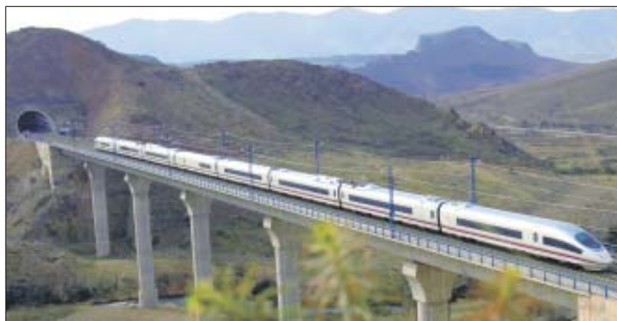
AVE S-103. Fabricado por Siemens y preparado para alcanzar una velocidad máxima de 350 km/h, ofrece 404 plazas, incluyendo dos para personas con movilidad reducida, distribuidas en Turista (264), Preferente (103) y Club (37). Está en comercialización desde 2007.
