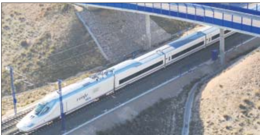
AVE S-102/112. Las series S102/112 estarán integradas en 2010 por 46 trenes construidos por el consorcio Talgo-Bombardier. Estos trenes ofrecen 316 plazas, con dos para personas con discapacidad: 193 en Turista, 76 en Preferente y 45 en Club. La serie 112 aumentará las plazas de Turista hasta 220, para un total de 348.
