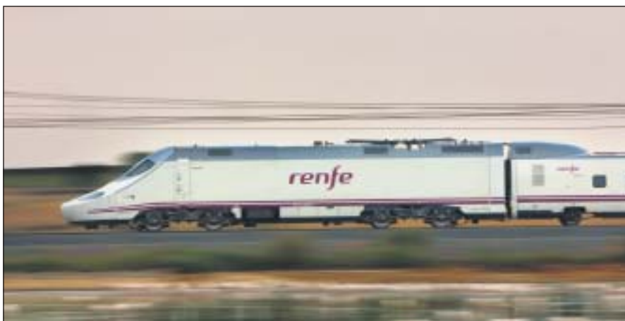
Alvia S-130. Esta serie de trenes, fabricada por el consorcio Talgo-Bombardier, estará integrada en 2010 por 45 vehículos. 26 de estos trenes circulan ya a una velocidad máxima de 250 km./h. en líneas de alta velocidad y de 220 km./h. en las convencionales.
