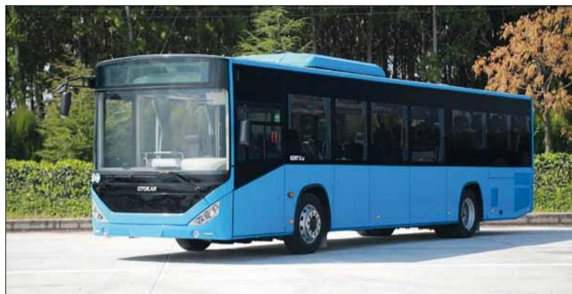
y Vectio C, el Kent U LE es un vehículo adaptado para una fácil accesibilidad, dispone de piso bajo (sin escalones) entre las puertas de entrada y de salida; la puerta de entrada está en la parte frontal y la de salida esta justo delante del eje trasero, y se usan tanto para el transporte urbano como para el transporte de mercancías, pudiendo ser homologado en Clase I y Clase II.
