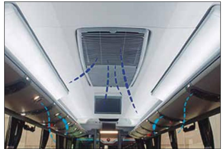
con la colaboración de la UFSM - Universidade Federal de Santa Maria en las actividades de medición de la potencia de la lámpara, evaluó la eficacia antimicrobiana de la radiación ultravioleta instalada en el aire acondicionado del autobús. Según el resultado, la tasa de eficiencia alcanzó más del 99%.
