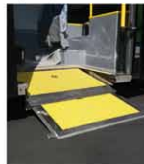
Rampa VICOLI: Rampa eléctrica para autobuses de piso bajo
