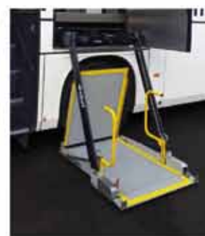
Rampa VICOLI: Rampa eléctrica para autobuses de piso bajo
