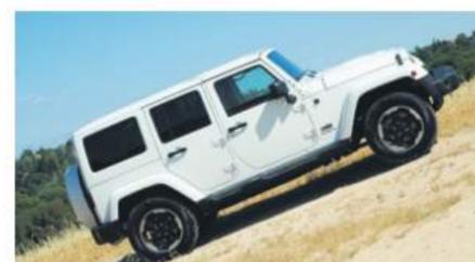
El sistema de reductora funciona con desniveles muy pronunciados
