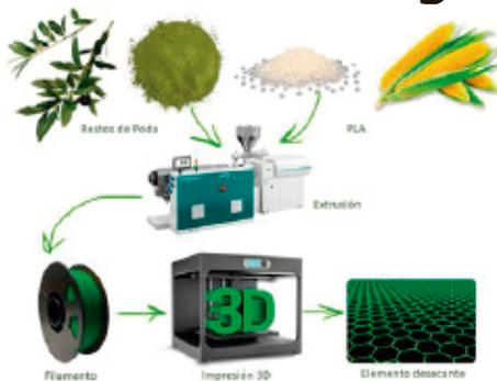
jo coste y alta eficiencia energética, promete mejorar la seguridad y eficiencia de los procesos productivos al reducir la aparición de moho, ralentizar la corrosión y minimizar los riesgos de accidentes por caídas. En concreto, el equipo está desarrollando un prototipo basado en una rueda desecante impresa en 3D, junto con un sistema de adquisición de datos que permitirá monitorizar su rendimiento en tiempo real.
