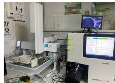
Figura 2. Automuestreador acoplado al equipo ESI-IMS suministrado por Excellims.
