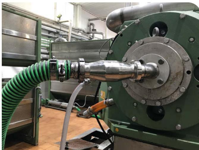
Detalle del aportador de agua perimetral en la centrífuga horizontal (2022).
