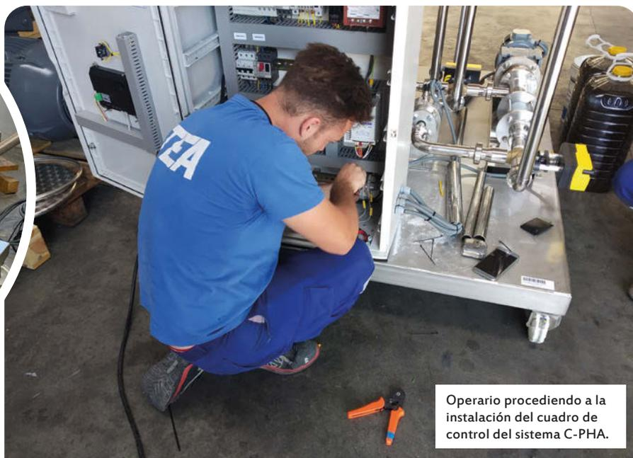
Operario procediendo a la instalación del cuadro de control del sistema C-PHA.
