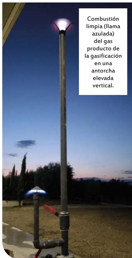
Combustión limpia (llama azulada) del gas producto de la gasificación en una antorcha elevada vertical.
