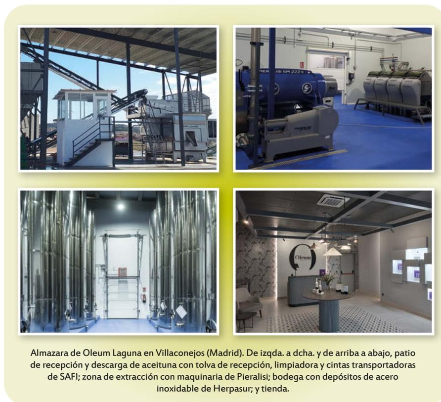
Almazara de Oleum Laguna en Villaconejos (Madrid). De izqda. a dcha. y de arriba a abajo, patio de recepción y descarga de aceituna con tolva de recepción, limpiadora y cintas transportadoras de SAFI; zona de extracción con maquinaria de Peralisi; bodega con depósitos de acero inoxidable de Herpasur; y tienda.
