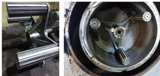
Figura 2. A la izquierda, rodillos acoplados al aspa del molino. A la derecha, el molino de la U.T.E. de Itea-Manzano instalado en Coesagro.
