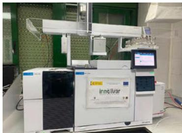
Figura 1. Espectrómetro de movilidad iónica acoplado a un cromatógrafo de gases-espectrómetro de masas (GC-MS/IMS) suministrado por Ingeniería Analítica.
