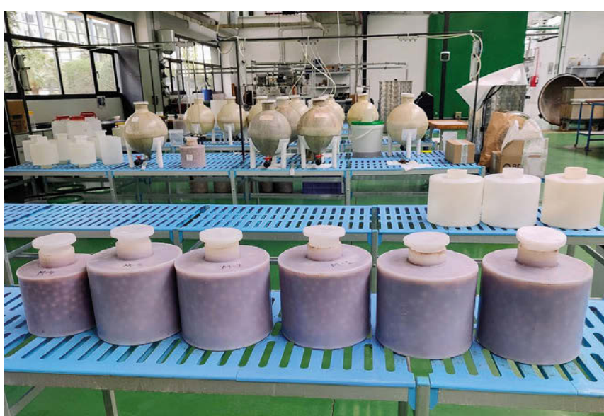
Figura 1. Fermentadores para la elaboración de aceitunas de mesa en planta piloto del Instituto de la Grasa.
