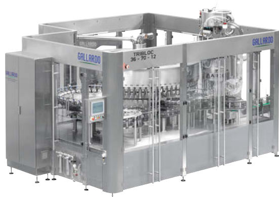
Tribloc 36-70-12, una llenadora electrónica y ponderal para aceite con una capacidad de 30.000 botellas/hora. Este equipo ha sido fabricado para Aceites La Corona, un cliente que en los últimos años ha adquirido 14 llenadoras de la firma guipuzcoana.
