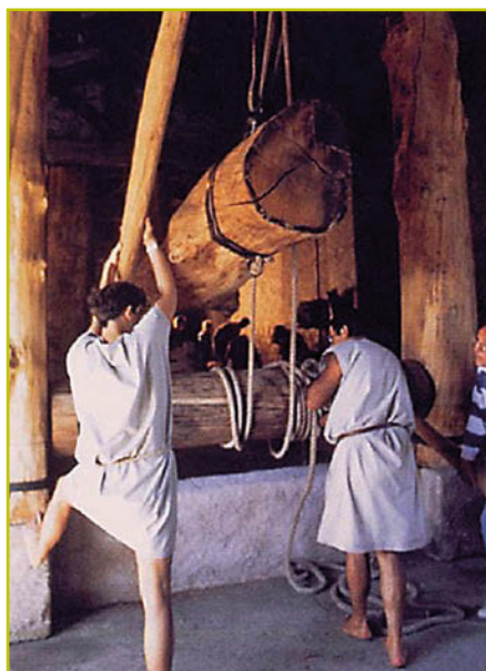
Figura 2. Prensa de torno utilizada en las almazaras romanas. Fuente: Sonia Blanco.
