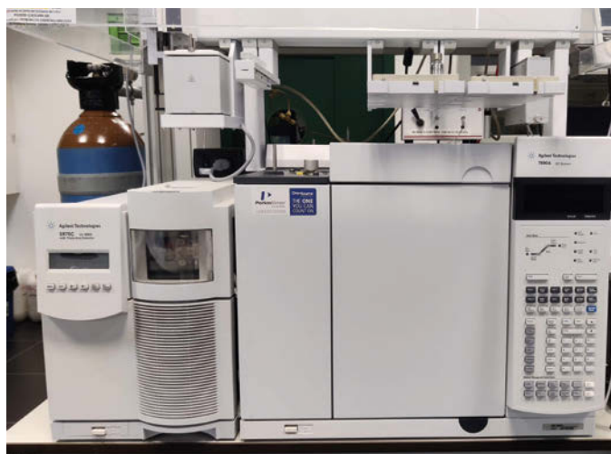
Figura 2. Equipo de cromatografía de gases con detector de espectrometría de masas utilizado para el análisis de compuestos volátiles de aceitunas de mesa.
