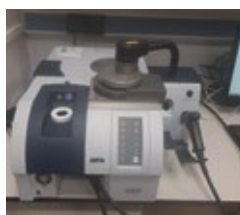
Figura 7. Equipo para análisis de aceite mediante espectroscopía de infrarrojo cercano (NIRS) y espectros característicos del AOVE.
