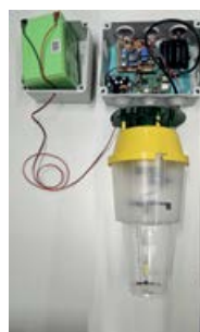
Figura 4. Prototipos finales de cada una de las trampas: trampa McPhail (izqda.), trampa polillero tipo funnel (centro) y trampa cromática amarilla (dcha.).
