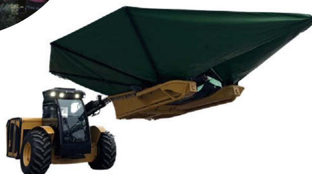
Este buggy permite seleccionar diferentes programas de vibración para optimizar la recolección según el tipo de plantación. Su pinza vibradora, con doble botella de apriete y motor central de masa variable, se adapta a diversos cultivos y garantiza una recogida eficaz.
