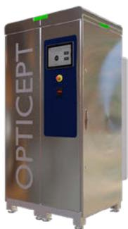
Un sistema PEF de OptiCept consta de un generador y una cámara de tratamiento. A medida que la pasta de aceituna pasa por la cámara, se trata con campos eléctricos pulsados en milisegundos o microsegundos, haciendo que el proceso sea muy eficiente sin aplicar calor.
