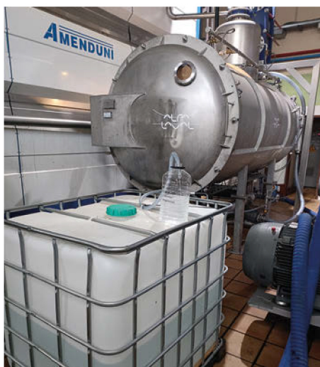
La obtención de este agua de aceituna (ADA) se ha llevado a cabo mediante un equipo patentado por la empresa Alfa Laval ( Booster ).
