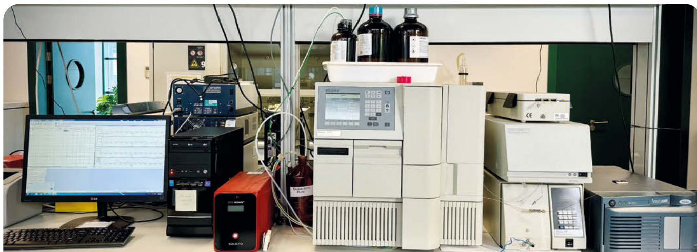
Equipo de HPLC-MS para la cuantificación de acrilamida en aceituna de mesa.
