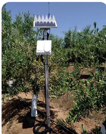
Las sondas de medición permiten aumentar la precisión del riego y gestionar mejor los recursos hídricos disponibles.
