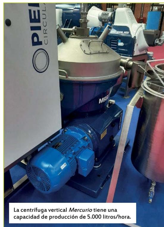
La centrífuga vertical *Mercurio* tiene una capacidad de producción de 5.000 litros/hora.
