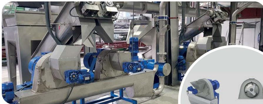
Los molinos de alta producción de Amenduni están contruidos en acero inoxidable y vienen provistos de rotores intercambiables de martillos o cuchillas que permiten al usuario dirigir la extracción.
