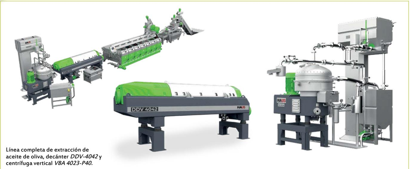
Línea completa de extracción de aceite de oliva, decánter DDV-4042 y centrífuga vertical VBA 4023-P40.
