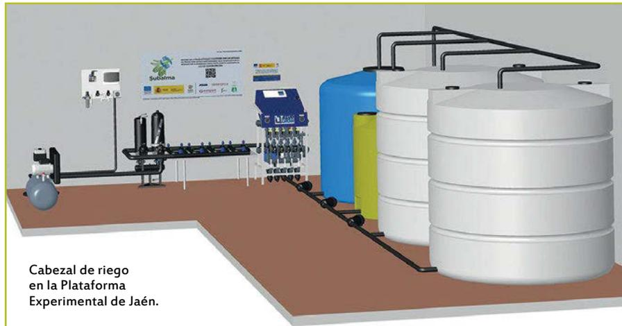
Cabezal de riego en la Plataforma Experimental de Jaén.
