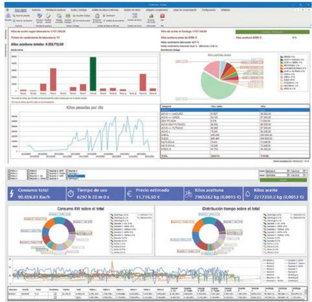
Software de trazabilidad *Tracking* (arriba) y módulo de control de eficiencia energética (abajo) desarrollados por IMATEC31.
