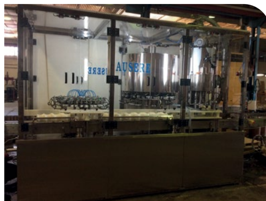
De izqda. a dcha., grupo rotativo de llenado por caudalímetros de 20 grifos; y triblock por caudalímetros para el envasado de botellas de hasta 1 litro.
