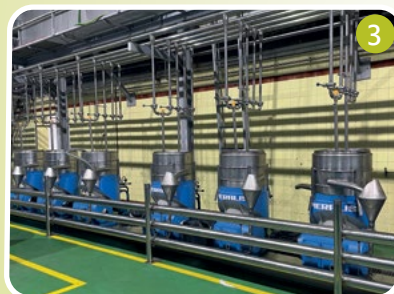
Instalaciones de la Cooperativa Olivarera Virgen de la Sierra de Cabra SCA. De izqda. a dcha., y de arriba a abajo, tolvas de almacenamiento de aceituna (1); centrifugas horizontales (2) y verticales (3) de Pieralisi en la zona de extracción; bodega principal (4); y tienda (5).
