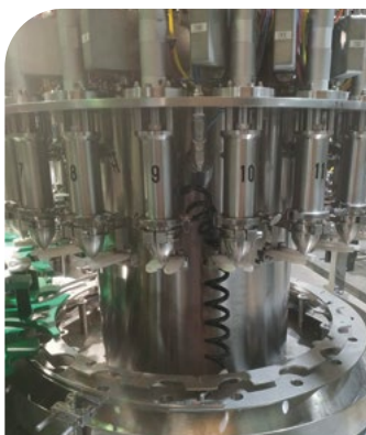
De izqda. a dcha., grupo rotativo de llenado por caudalímetros de 20 grifos; y triblock por caudalímetros para el envasado de botellas de hasta 1 litro.
