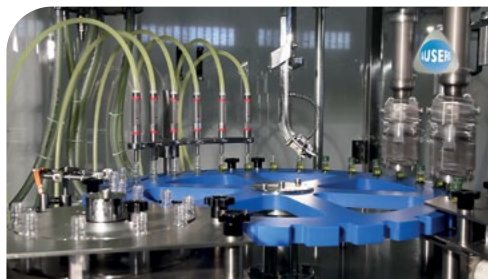
De izqda. a dcha., monoblock rotativo intermitente para el llenado y tapado pilfer de envases de miniaturas desde 10 hasta 100 ml. de aceite; monoblock lineal HAM-3/FM con tres grifos para el llenado y tapado a rosca de garrafas PET de 20 y 25 litros.
