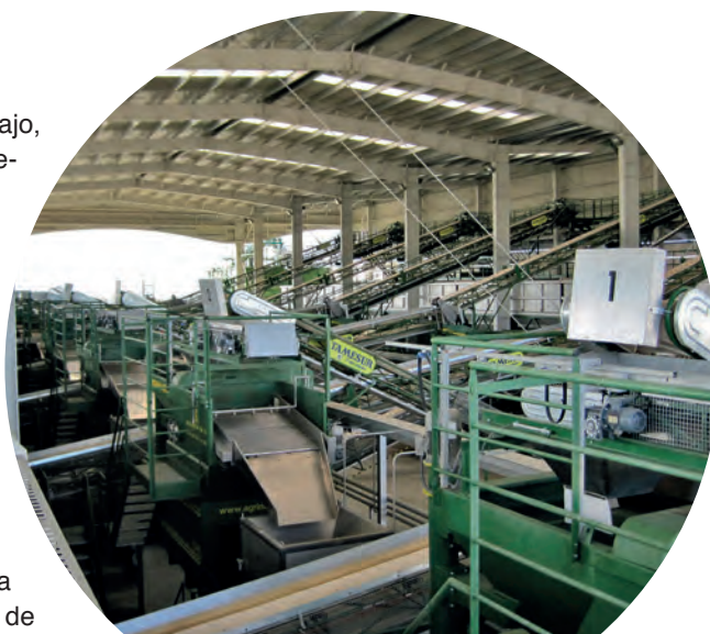
Foto superior: zona de eliminación de impurezas de las aceitunas (al fondo, las tolvas pulmón) y limpiadora con duchas con aceitunas de principios de campaña (foto inferior).
