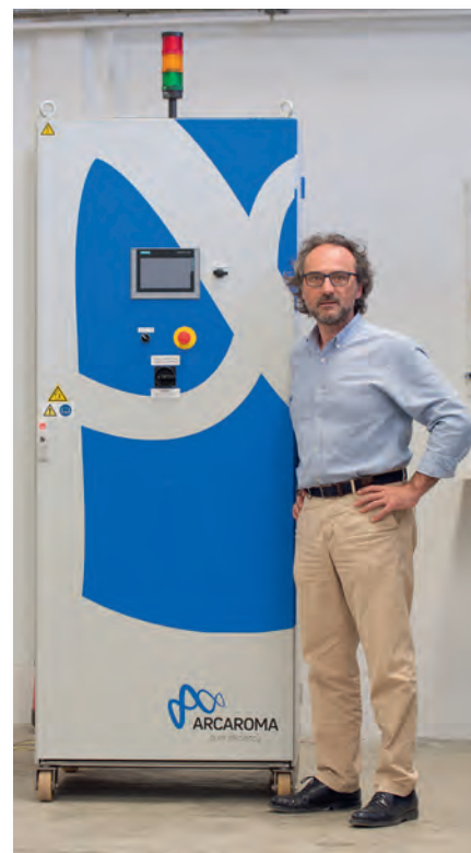
La instalación de OliveCEPT® es rápida y no implica reformas ni modificaciones en la línea de extracción. Además, el consumo de energía es de tan sólo 5,2 o 9,2 kW, dependiendo del modelo.
