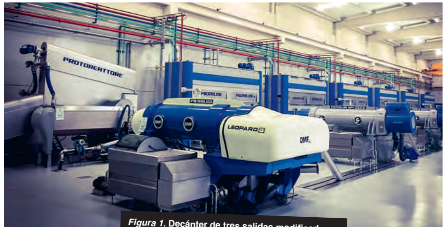
Figura 1. Decánter de tres salidas modificadas.
