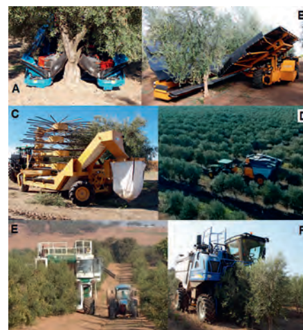
Figura 3. Tipología de las diferentes plantaciones de olivar y sus tipos de recolección mecanizada: A y B) Intensiva de riego (200-400 árboles/ha., con vibradores de tronco y tipo side-by-side); C, D y E) Alta densidad (450-800 árboles/ha., con cosechadora lateral basada en sistemas sacudidores de copa-prototipo UCO/Moresil, vendimiadora modificada arrastrada por tractor CV5045 de Pellenc y con grandes cabalgadoras tipo Colossus S); y F) Seto (≥ 1.000 árboles/ha., con vendimiadora modificada autopropulsada NH7090.
