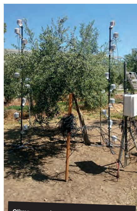
Olivar sensorizado para determinar el perfil de temperaturas y su correlación con la fenología.
