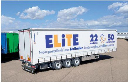
**Características:** Nueva generación de semirremolques lonas. Incrementan la resistencia, la durabilidad, facilitan el manejo, generan menos mantenimientos y se ha optimizado un 5% su tara. El frente y la trasera de la carrocería es un 20% más resistente, el piso tiene doble fijación al chasis y es igualmente un 15% más resistente.
