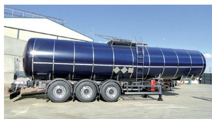
**Características:** Sección tronco-cónica con una capacidad de 33.000 litros, fabricadas bajo normativa ADR e IMDG para transporte por carretera y por vía marítima. Preinstalación para seis resistencias eléctricas y termostato, pasarela y barandilla situadas alrededor del cajón antiderrame y medidas de seguridad mediante un sistema de seguridad accionado neumáticamente con apertura secuencial, detección de parking accionado y manguera conectada.
