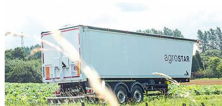
**Características:** Basculante con bastidor y caja de aluminio para transporte de productos agrarios, abonos, despojos, palets... Eje de volteo integrado en el chasis y anchura del bastidor de 1.400 mm.
