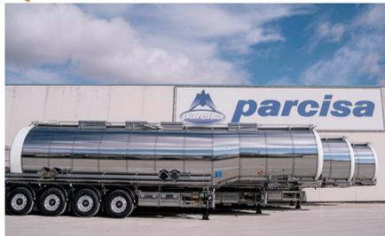
**Características:** Cisterna para transporte de productos químicos, productos corrosivos, monocubas o compartimentadas, en material de acero inoxidable especial para su comportamiento. También autoportante destinada para un transporte
