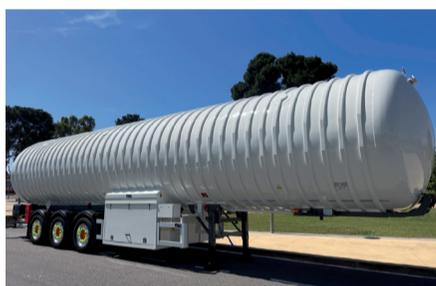
**Características:** Semirremolques cisterna criogénicos TPED para el transporte de gases liquados refrigerados, con aislamiento térmico en vacío multicapa (MLI) y equipamientos de distribución diseñados para garantizar la mayor protección térmica, seguridad y velocidad de descarga del mercado: (LNG) Gas natural liquado; (LIN) Nitrógeno liquado; (LAR) Argón liquado; (LCO2) CO2 liquado; (LOX) Oxígeno liquado; y Etileno liquado.
