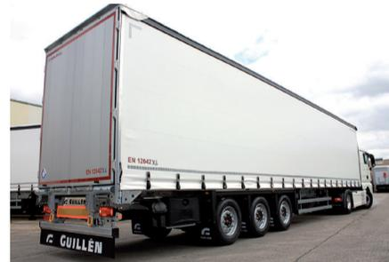
**Características:** El nuevo semirremolque G-120 PRO sustituye al reputado G-110. Incluye numerosas ventajas, proporcionando una mejora considerable en resistencia además de una reducción en la Tara. MMTA hasta 41.000 kg.
