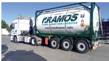
**Características:** Contenedor de sección cilíndrica, capacidad 28.800 litros con un rompeolas, 20 pies, forrados en poliéster, cajones cuadrados antiderrame, normativa ATP, 6 líneas para vapor.
