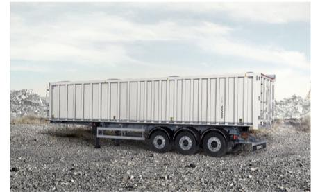
**Características:** Basculante para transporte de chatarra fragmentada. 10.600 y 11.600 mm de longitud; y 1.900, 2.000 y 2.100 mm de altura. Capacidad entre 48 y 58 m<sup>3</sup>.
