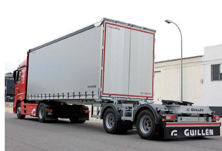
**Características:** Equipado con sistema de frenos EBS con CAN router, el Sistema RSS de ayuda contra el vuelco. Además incluye un sistema tándem de dos ejes desagregados con freno de disco de 19"5,
