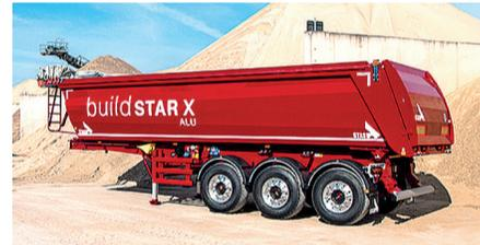
**Características:** Basculante con bastidor y caja de aluminio para transporte de arena, grava, tierra, arcilla, lodo, piedras pequeñas, asfalto... Eje de volteo integrado en el chasis y anchura del bastidor de 1.400 mm.
