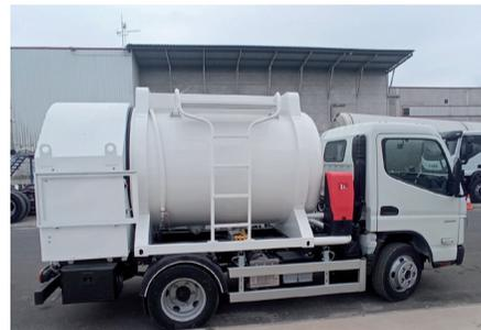
**Características:** Cisterna de reparto de 3 m3 compartimentada. NO CLH, para el transporte de gasoil y diseñada con normativa de unidad apilable-desmontable para poder cumplir con la nueva homologación del carrozado. Esta unidad esta diseñada de manera que facilita al conductor todos los detalles y equipos para poder adaptarse a cualquier tipo de ciudad y calles. Lleva montada un equipo compacto de 400 litros con una bomba y contador + devanadera axial con 50 m de manguera de Ø 32.
