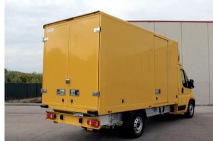
un uso más intensivo o agresivo. Laterales y frontal compuestos por paneles Liderwood, con núcleo de madera de alta calidad-resistencia y caras exteriores de poliéster. Dos versiones: una más ligera, con paneles de 14 mm, y otra más reforzada con paneles de 17 mm. Acabado con todas las opciones disponibles.
