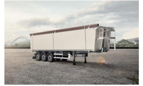
**Características:** Sello de identidad premium de los basculantes de Tisvol. Chasis con reducción total de momentos flectores provocados por la descarga. Se reduce la altura del chasis en 70 mm. Dos opciones de carrocería: la CC y la E-30. Exclusivo Frontal H que combina las características del Frontal I y el Frontal E.
