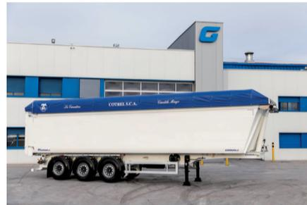
**Características:** El semirremolque G-Aero, tiene una longitud útil desde 9 a 10,5 m con volúmenes desde 35 a 61 m<sup>3</sup>, y su composición está formada por láminas horizontales soldadas al 100% y un perfil inferior curvo que le confiere aerodinámica y diseño. Dentro de sus características principales, el fabricante destaca: mayor aerodinámica y máxima carga útil, sin olvidarnos de la ligereza y robustez que caracterizan a todos los vehículos Granalu".
