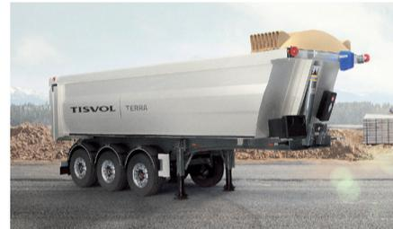
**Características:** Basculante para movimiento de tierras y asfaltos. 8.300 mm de longitud con una altura de 1.400 mm ó 8.700 mm con una altura de 1.500 mm. Capacidad entre 25 y 30 m<sup>3</sup>. Frontal inclinado 21° modelo E.
