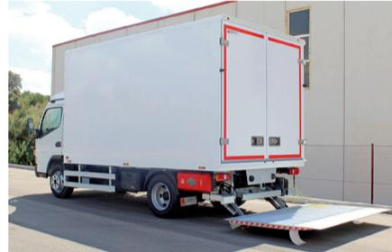
**Características:** Es el modelo ultraligero, compuesto por laterales y frontales fabricados con paneles Liderfoam de 18 mm, tipo sándwich. Mantiene el sistema propio de perfilera del fabricante, que, en conjunción con los paneles y poliéster de fabricación propia, le otorgan una gran resistencia.
