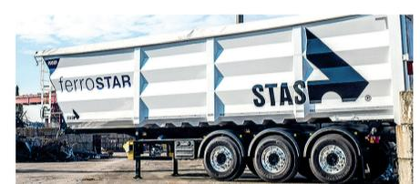
**Características:** Basculante con bastidor y caja de acero, para el transporte de chatarra y bobinas de acero. Eje de volteo integrado en el chasis y anchura del bastidor de 1.400 mm.
