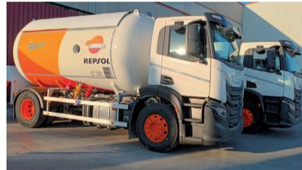
**Características:** Cisterna de reparto de 17 m3 mono-cuba para el reparto de productos de la Clase 2 (ADR) con equipos de transvase cetil con bomba y contador ME4000, con sonda de temperatura y una devanadera Axial para 40 m. Esta unidad esta construida bajo los detalles y normativa de Repsol.
