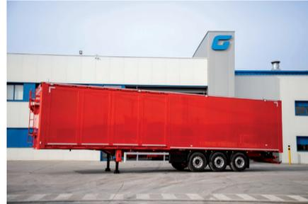
**Características:** Gama dividida en dos tipos, con volúmenes de hasta 94 m<sup>3</sup>: cargas generales a granel (serrines, astilla, abonos, madera, cereal...) y RSU (recogida de residuos sólidos urbanos con total seguridad debido a su estanqueidad y recogida de lixiviados). Los pisos móviles de cargas a granel también están disponibles con techo elevable. "Dos de cada tres pisos móviles en España son fabricados por Granalu", afirma la compañía.
