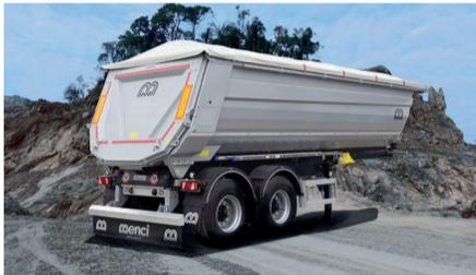
**Características:** La bañera Giove de Menci es adecuada para el transporte de todo tipo de materiales de construcción como áridos, tierras, aglomerados, rocas, balastro, piedras, escollera, etc. Fabricada en acero Hardox 500 TUF.
