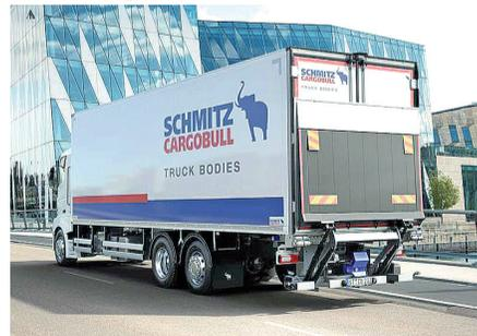
**Características:** Carrocerías de furgón y frigorífico para camión rígido M.KO de alto rendimiento para el transporte con temperatura controlada sobre vehículos básicos de todos los fabricantes habituales de camiones.
