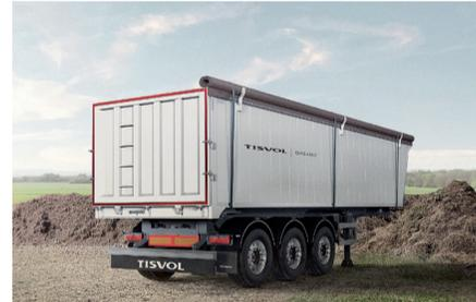
**Características:** Basculante para transporte de residuos. Tres posibles longitudes combinadas con un rango de alturas: 9.100, 9.600 y 10.600 mm de longitud; y entre 1.600 y 1.900 mm de altura. Capacidad entre 35 y 50 m<sup>3</sup>.
