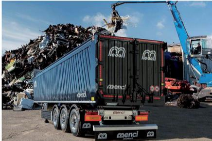
**Características:** Vehículo diseñado para el transporte de residuos férricos tipo chatarra. La caja está construida integralmente en acero Hardox 450 (diferentes espesores) y el chasis se puede fabricar tanto en acero como en aluminio para minimizar la tara y aumentar la carga útil.
