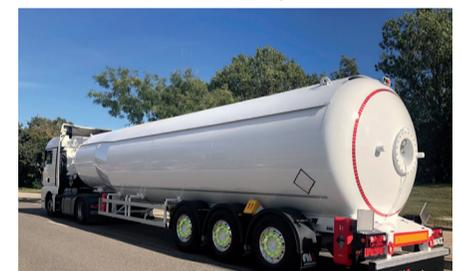
**Características:** Semirremolque cisterna para el transporte y distribución de GLP, equipado con tuberías de carga y descarga con bomba, medidor y manguera, con amplias opciones de sistemas de control, seguridad, accesorios, tipos de rodaje y sistemas de freno. Homologado para el transporte por carretera y el transporte marítimo (ADR - IMDG).
