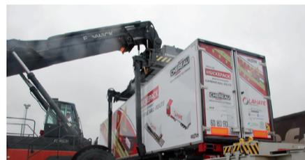
**Características:** El transporte combinado por ferrocarril y carretera requiere equipos específicos con carrocerías frigoríficas desmontables montadas sobre un chasis para la carretera y sobre una plataforma de tren para el ferrocarril. La carrocería debe tener integrado el depósito de carburante y ser independiente del chasis. También debe poseer un diseño especial para las repetidas operaciones de transbordo con grúas de pinzas.
