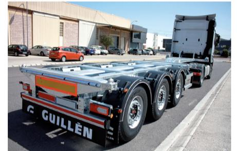
**Características:** Chasis galvanizado en caliente con garantía de 10 años. Tres ejes con freno de disco de 430 mm. Eje delantero adelantado con distancia al segundo de 1.410 mm.
