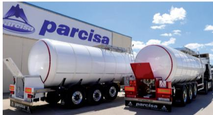
**Características:** Cisterna para transporte de productos asfálticos y bituminosos, fabricada en acero o acero inoxidable. Sistema de calentamiento mediante resistencias eléctricas o mediante quemador.
