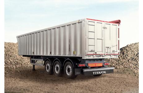
**Características:** Basculante de múltiples cargas para graneles medios. 9.600 y 10.600 mm de longitud; y 1.800, 1.900 y 2.000 de altura. Capacidad entre 41 y 50 m<sup>3</sup>.
