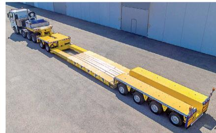
**Características:** La gama de camas extra bajas ofrece estructura con alturas desde solo 120 mm. Versiones telescópicas de simple o doble expansión, dolly desmontable, cuellos de vigas laterales y capacidades de cargas hasta 140 ton.
