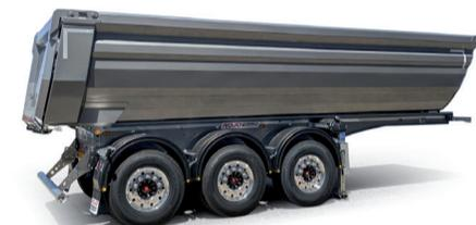
**Características:** Con AluHARD 500/44+ "evolucionamos el diseño para adaptarlo a las 44 tn", explican desde el fabricante. Con ejes SAF en su versión CD homologados de 9 tn. y preparados para su uso constante con estos pesos y en todas condiciones. Con el aumento de 180 mm en el chasis y la caja hacia adelante, subiendo la carga resultante sobre el King-Ping, pero manteniendo un voladizo trasero perfecto para asfaltar.
