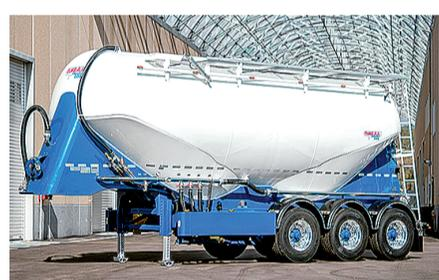
**Características:** Semirremolque cisterna autoportante para arena, azúcar, cemento, ceniza volante, forraje, harina...
