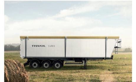
**Características:** Basculante versátil para graneles medios y palets. 10.600 y 11.600 mm de longitud; y 1.900, 2.000, 2.100 y 2.200 de altura. Capacidad entre 50 y 63 m<sup>3</sup>.
