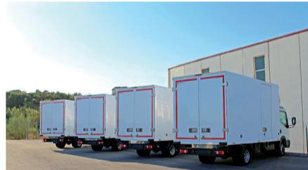
**Características:** Carrocería fabricada en chapa de aluminio con refuerzos internos tipo omega. Máxima ligereza para un rango de uso muy extenso, aunque el más usual es el transporte de mobiliario o similares, ya que permite la instalación de numerosos opcionales para la sujeción y protección de este tipo de mercancía.
