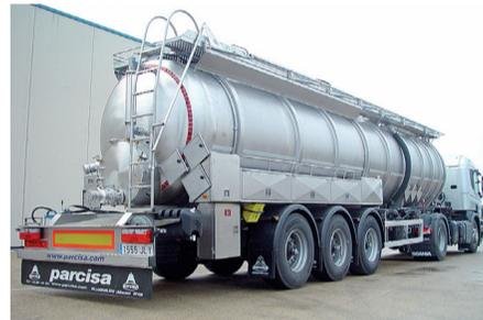
**Características:** Cisterna combinada de alta precisión y vacío en acero inoxidable, sobre camión o remolque, destinada al tratamiento de residuos (bajo normativa ADR), con sistema de limpieza a presión y bomba de absorción.
