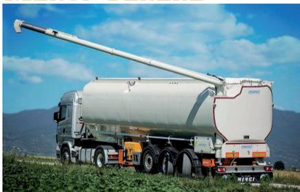
**Características:** La cuba Venere de Menci en formato remolque o semirremolque es un vehículo para el transporte de piensos animales a granel. Construcción integral Menci Group en aluminio de primera calidad y soldaduras totalmente robotizadas con múltiples posibilidades de dividir la carga en diversos compartimentos independientes entre ellos.
