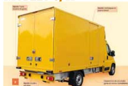
**Características:** Modelo resistente para un uso más intensivo o agresivo. Laterales y frontal compuestos por paneles Liderwood, con núcleo de madera de alta calidad-resistencia y caras exteriores de poliéster. Dos versiones: una más ligera, con paneles de 14 mm, y otra más reforzada con paneles de 17 mm. Acabado con todas las opciones disponibles.
