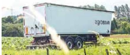
**Características:** Basculante con bastidor y caja de aluminio para transporte de productos agrarios, abonos, despojos, palets... Eje de volteo integrado en el chasis y anchura del bastidor de 1.400 mm.
