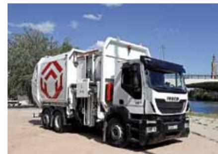
**Características:** Recolector de carga lateral que utiliza la última tecnología para trabajar con contenedores entre 760 y 3.200 litros de capacidad. Cuenta con software propio y cinco cámaras para un control total del ciclo de carga. Solera, frontales de tolva y caja en aceros Hardox. Sistema multicontrol en la pantalla de la cabina, posibilidad de accionamiento manual, sistema anti-atasco en la tolva y baja emisión de ruidos (102 dB).
