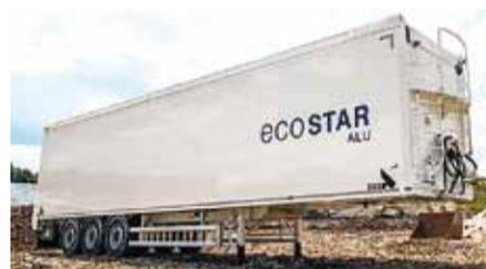
**Características:** Piso móvil con bastidor de aluminio o acero y caja de aluminio, para el transporte de chatarra, residuos domésticos, vidrio... Estructura superreforzada y marco posterior reforzado para carretillas elevadoras.
