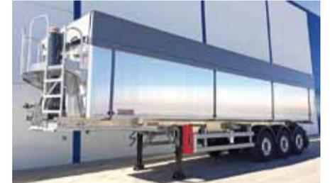
**Características:** Semirremolque con chasis y basculante de aluminio.
