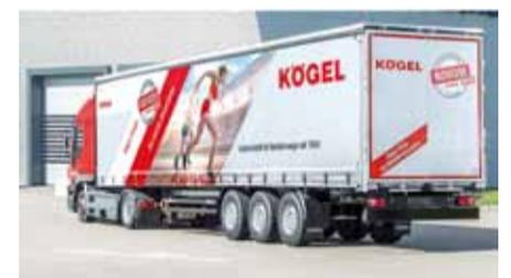
**Versiones:** Kögel Cargo (coil, papel, ferry y Coil rail, bebidas, automoción), Mega (coil, ferry, ferrocarril y papel) y Lightplus (tara reducida de 4.822 kg, para coil, papel y bebidas) de la generación NOVUM. También para transporte de bobinas.
