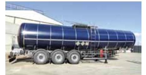
**Características:** Sección tronco-cónica con una capacidad de 33.000 litros, fabricadas bajo normativa ADR e IMDG para transporte por carretera y por vía marítima. Preinstalación para seis resistencias eléctricas y termostato, pasarela y barandilla situadas alrededor del cajón antiderrame y medidas de seguridad mediante un sistema de seguridad accionado neumáticamente con apertura secuencial, detección de parking accionado y manguera conectada.
