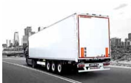
**Características:** El semirremolque Kässbohrer, con caja de madera contrachapada, de la serie K.SBT y el semirremolque City, con dirección forzada y caja de madera contrachapada, de la serie K.SBT C, están diseñados para operaciones robustas y versátiles. El K.SBT está diseñado con su chasis completo de acero S460MC de alta resistencia para condiciones de carretera difíciles. El K.SBT C está especialmente diseñado para carreteras urbanas estrechas gracias a su eje de dirección mecánico.
