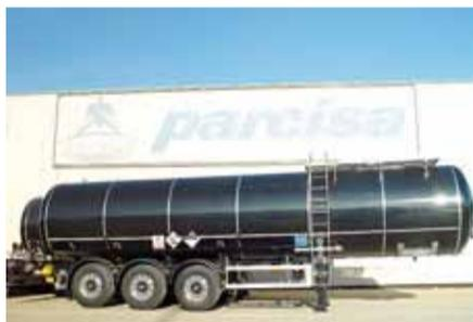
**Características:** Cisterna para transporte de productos asfálticos y bituminosos, fabricada en acero o acero inoxidable. Sistema de calentamiento mediante resistencias eléctricas, o mediante quemador.
