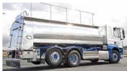
**Versiónes:** Adaptadas bajo normativa ADR; y para productos alimenticios en dos (formato elíptico o policéntrico), tres (leche y líquidos con o sin equipo laboratorio) y cuatro ejes (con ejes separados y con cámara trasera).
