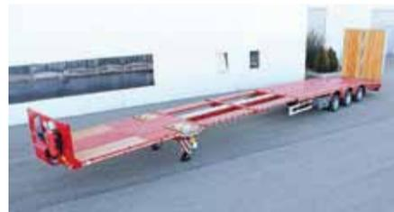
**Características:** Plataformas de 2 a 6 ejes. Con longitud fija o hasta cuatro expansiones (4X). Ofrece modelos extensibles que alcanzan longitudes de 65 metros.
