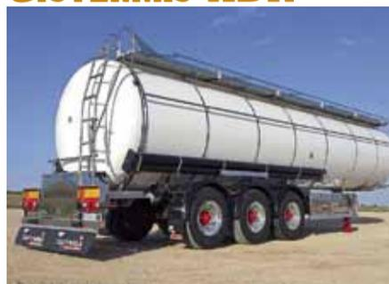
**Características:** Cisterna para transporte de mercancías peligrosas. CON o SIN Isotermo, autoportante fija o desmontable, cuerpo cilíndrico, cuello de cisne.
