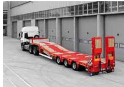
**Características:** Para nuestras plataformas bajas, Kässbohrer produce modelos con hasta ocho ejes en sus versiones estándar, con chasis extraíble, controles hidráulicos y ejes de dirección hidráulica. En la serie de carga baja, se puede elegir entre los modelos de dos a un máximo de cuatro ejes. Además, ofrecemos numerosas opciones de seguridad y alta movilidad para los procesos de carga y descarga por el diseño de cuello de cisne atornillado.
