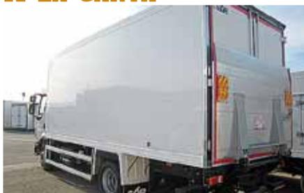
**Características:** Las unidades de MMA hasta 12.000 kg SOR tienen la flexibilidad suficiente para transportar temperatura positiva o negativa. Admiten todo tipo de composición interior con estanterías, paletizado, bandejas, encajado, etc.
