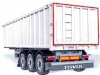
**Características:** Basculante para transporte de residuos. Tres posibles longitudes combinadas con un rango de alturas: 9.100, 9.600 y 10.600 mm de longitud; y entre 1.600 y 1.900 mm de altura. Capacidad entre 35 y 50 m<sup>3</sup>.
