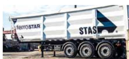
**Características:** Basculante con bastidor y caja de acero, para el transporte de chatarra y bobinas de acero. Eje de volteo integrado en el chasis y anchura del bastidor de 1.400 mm.
