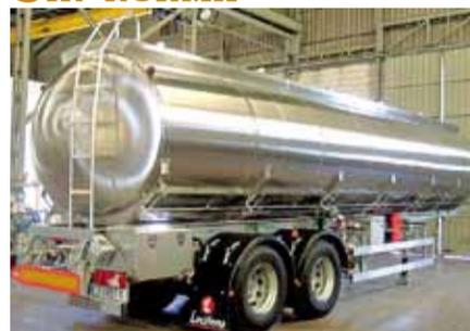
**Características:** Cisternas para transporte de mercancías que no estén reguladas por ninguna normativa. Acero inoxidable, aluminio o acero carbono, cisterna CON o SIN isotermo, autoportante fija o desmontable, cuerpo cilíndrico o cuello de cisne, sección cilíndrica u ovalada.
