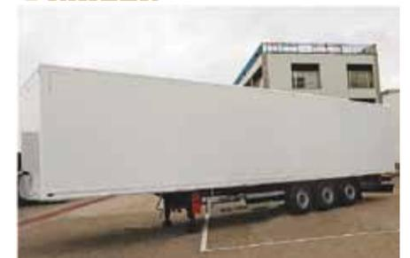
**Características:** Novedad. Capacitado para transportar hasta 40 toneladas de peso, posee propiedades especiales en resistencia y durabilidad. Su pieza más extensa mide 13.600x2.700 mm y está elaborada en una única estructura, sin divisiones de elementos.
