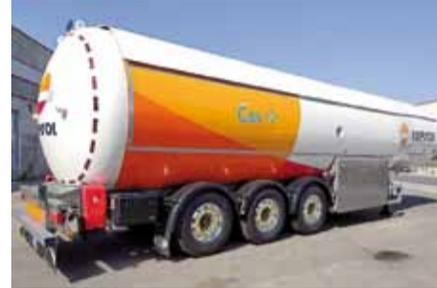
**Características:** Cisterna autoportante para transporte de gas licuado de petróleo, construida sobre tren de rodadura de uno, dos o tres ejes con varias opciones de equipo de descarga. Gran variedad de diseños y capacidades.
