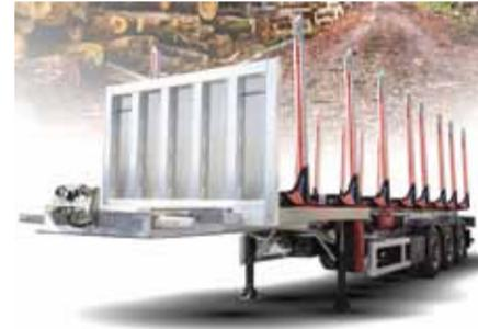
**Características:** Vehículo integral de aluminio con sistema de postes Exte/Ecco para el transporte de madera. Tara de 5.280 kg, con posibilidad de incorporar una grúa frontal. robustez, versatilidad y mayor carga útil.
