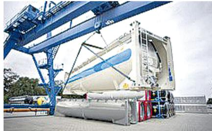
**Características:** Bastidor basculante en una construcción soldada de acero, o de forma opcional en una construcción atornillada y soldada fabricada en una aleación de aluminio especial.
