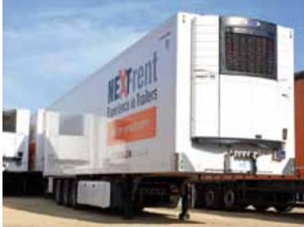
**Características:** Frigorífico estándar, maxi, mega, multi temperatura, doble piso, carga aérea, piso aluminio, puertas laterales. Todas con la opción EN-12642 código XL para una carga neta de 27.000 kg hasta 3.000 mm de altura. G.L.S.S. (Guillén Load Security System) Sistema patentado de cierre con opción de aviso telemático en caso de apertura.
