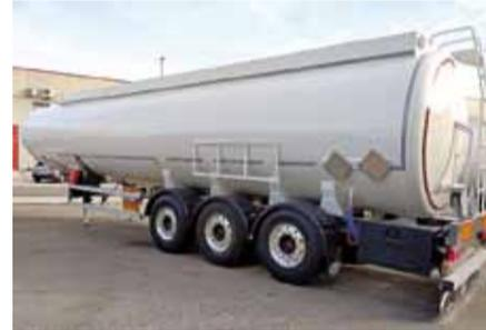
**Características:** Cisterna autoportante para transporte de queroseno, repostaje de helicópteros y aeronaves.
