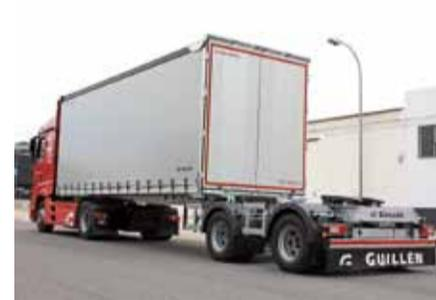
**Características:** Equipado con sistema de frenos EBS con CAN router, el Sistema RSS de ayuda contra el vuelco. Además incluye un sistema tándem de dos ejes desagregados con freno de disco de 19"5, lo que aporta una capacidad de carga sobre ejes de hasta 20 toneladas. Las configuraciones de altura de 5ª rueda pueden ir desde los 1.050 hasta los 1.180 mm.
