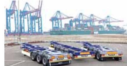
**Características:** El chasis portacontenedores S.CF 40' LX ofrece el diseño adecuado cuando la prioridad está en el transporte eficiente de contenedores de 20' y 40'. Transporta contenedores de 20' enrasados atrás, así como dos de 20' y de 40' con túnel. La extensión trasera con tubo central neumático se maneja de forma sencilla y en poco tiempo, y no requiere de ajustes para los contenedores de 40' sin túnel.
