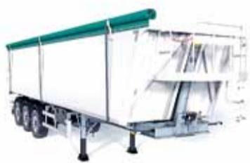
**Características:** Basculante para movimiento de restos biológicos. 10.100 y 10.600 mm de longitud; y entre 1.700 y 2.100 mm de altura. Capacidad entre 42 y 55 m<sup>3</sup>.
