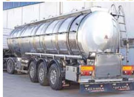
**Características:** Cisternas polivalentes para transporte de mercancías por carretera. Acero inoxidable AISI 304L o AISI 316L, cisterna con isotermo, autoportante fija o desmontable, cuerpo cilíndrico, cuello de cisne.
