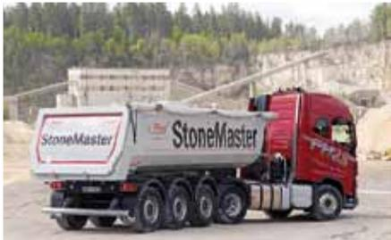
**Características:** Volquetes para construcción que, gracias a su proceso de fabricación, reducen hasta un 10% el consumo. Materiales ligeros de alta resistencia, paquete aerodinámico, chasis curvo, centro de gravedad rebajado...
