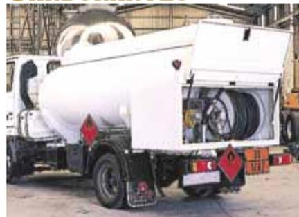
**Características:** Cisternas para transporte de carburantes. Aluminio y otros materiales a petición del cliente. Cisterna SIN isotermo, montaje sobre auto-bastidor y chasis semirremolque, sección elíptica o panorámica.
