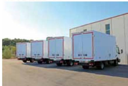
**Características:** Carrocería fabricada en chapa de aluminio con refuerzos internos tipo omega. Máxima ligereza para un rango de uso muy extenso, aunque el más usual es el transporte de mobiliario o similares, ya que permite la instalación de numerosos opcionales para la sujeción y protección de este tipo de mercancía.
