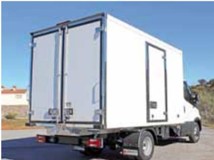
**Características:** Carrocería diseñada para la gama ligera de vehículos industriales. Ha sido concebida para maximizar la carga útil debido a su ligereza, sin dejar de lado su resistencia y durabilidad.
