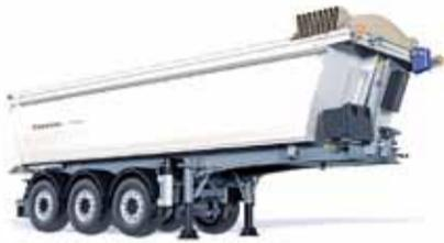
**Características:** Basculante para movimiento de tierras y asfaltos. 8.300 mm de longitud con una altura de 1.400 mm ó 8.700 mm con una altura de 1.500 mm. Capacidad entre 25 y 30 m<sup>3</sup>. Frontal inclinado 21° modelo E.
