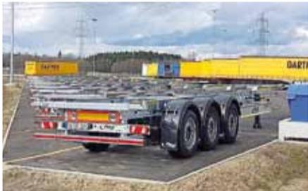
**Características:** Chasis para transporte de contenedores entre 20 y 45". Variedad de posibilidades, capacidad de carga útil, construcción robusta, desde eje simple para aplicaciones urbanas hasta cuatro ejes con uno direccional.
