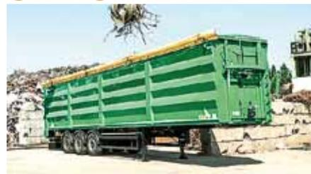
**Características:** Piso móvil con bastidor y caja de acero, para el transporte de chatarra ligera, chatarra pesada o ruinas. Diseño exclusivo de Stas en acero Hardox V9 Keith walking floor.
