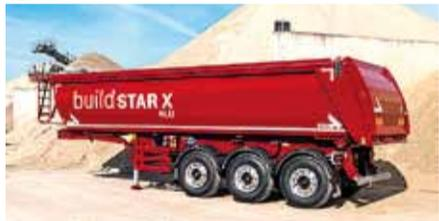
**Características:** Basculante con bastidor y caja de aluminio para transporte de arena, grava, tierra, arcilla, lodo, piedras pequeñas, asfalto... Eje de volteo integrado en el chasis y anchura del bastidor de 1.400 mm.
