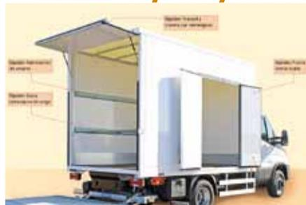
**Características:** Sus laterales y frontales están compuestos por paneles Liderfoam. Modelo muy ligero pero a la vez tan resistente que está disponible para carrocerías de hasta 26 Ton. Es totalmente personalizable gracias a la fabricación propia de paneles (tipo sandwich). Admite refuerzos internos o externos y de
