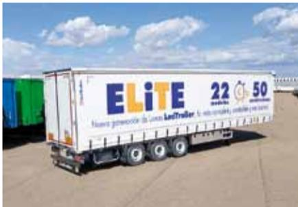
**Características:** Nueva generación de semirremolques lonas. Incrementan la resistencia, la durabilidad, facilitan el manejo, generan menos mantenimientos y se ha optimizado un 5% su tara. El frente y la trasera de la carrocería es un 20% más resistente, el piso tiene doble fijación al chasis y es igualmente un 15% más resistente.
