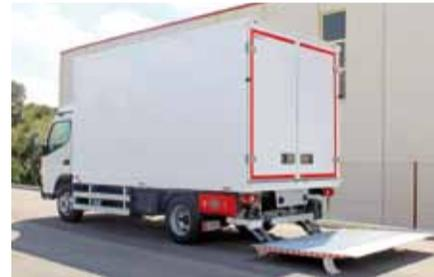
**Características:** Sus laterales y frontales están compuestos por paneles Liderfoam de 18 mm, tipo sandwich. Mantiene el sistema propio de perfilaría del fabricante, que en conjunción con los paneles y poliéster de fabricación propia, le otorgan una gran resistencia.
