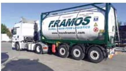
**Características:** Contenedor de sección cilíndrica, capacidad 28.800 litros con un rompeolas, 20 pies, forrados en poliéster, cajones cuadrados antiderrame, normativa ATP, 6 líneas para vapor.
