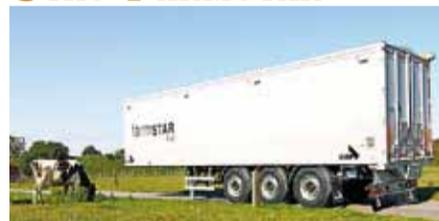
**Características:** Piso móvil con bastidor y caja de aluminio, para el transporte de sacas (big bags). Calidad de aluminio premium y marco posterior reforzado para carretillas elevadoras.
