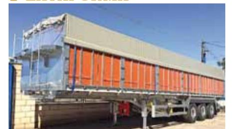
**Características:** Plataforma basculante de aluminio con laterales abatibles de aluminio o poliéster. Chasis con escudos integrados para cilindros internos.
