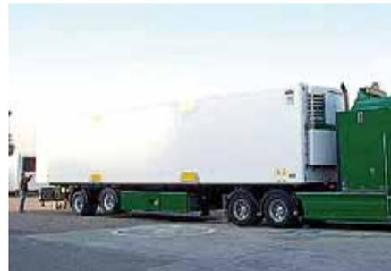
**Características:** SOR Ibérica fabricó su primera caja móvil en 1989 y fue construida con una estructura metálica similar a la de los contenedores y un peso, sin equipo de frío, de 5.375 kg. En la actualidad, el peso de la caja móvil sin equipo ronda los 4.700 kg, dependiendo de la especificación final. Cajas móviles de 20" y 40" y huckpack con cualquier tipo de especificación isoterma o frigorífica.
