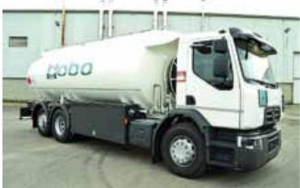
**Características:** Cisternas de reparto de combustibles, gama amplia y variada, las capacidades van desde los 3.000 litros en camiones de de ejes hasta los 20.000 litros en camiones con tres ejes. Normalmente se fabrican en aluminio, con las capacidades y número de compartimentos que
