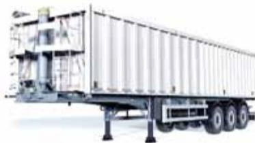
**Características:** Basculante para transporte de chatarra fragmentada. 10.600 y 11.600 mm de longitud; y 1.900, 2.000 y 2.100 mm de altura. Capacidad entre 48 y 58 m<sup>3</sup>.
