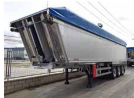
**Características:** Semirremolque con chasis y basculante de aluminio.
