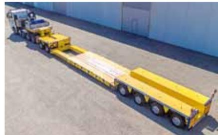
**Características:** La gama de camas extra bajas ofrece estructura con alturas desde solo 120 mm. Versiones telescópicas de simple o doble expansión, dolly desmontable, cuellos de vigas laterales y capacidades de cargas hasta 140 ton.
