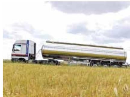
de cisterna también se puede construir para presión, con presiones de prueba de 2,9 bar. Acero inoxidable AISI 304L o AISI 316L, cisterna con Isotermo, autoportante fija o desmontable, cuerpo cilíndrico, cuello de cisne.
