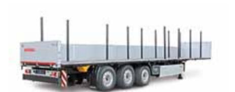
**Características:** El Kögel Multi es la solución para el transporte de materiales de construcción y mercancías resistentes a la intemperie. El chasis de varios tipos de vehículos (Kögel Cargo, Mega, Coil y Light) sirve como base y se completa con una carrocería compuesta por una pared delantera, cartolas laterales y una pared trasera. De este modo, el Multi está disponible en una amplia gama de variantes.
