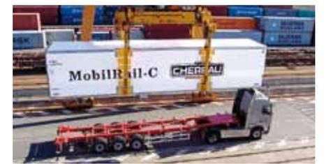
**Características:** El transporte combinado por ferrocarril y carretera requiere equipos específicos con carrocerías frigoríficas desmontables montadas sobre un chasis para la carretera y sobre una plataforma de tren para el ferrocarril. La carrocería debe tener integrado el depósito de carburante y ser independiente del chasis. También debe poseer un diseño especial para las repetidas operaciones de transbordo con grúas de pinzas.
