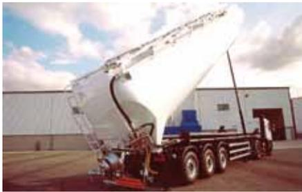
**Características:** Semirremolques con destino al transporte de materias pulverulentas. Dos tipos de unidades: los semirremolques basculantes y los semirremolques de tolvas, que en ambos casos pueden incorporar compresores para la descarga. Normalmente su fabricación es en aluminio, pero se puede ofrecer la posibilidad de fabricar también en acero al carbono.
