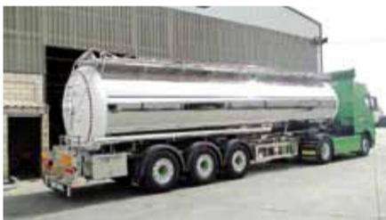
**Características:** Cisterna cilíndrica-recta ADR para el transporte de mercancías peligrosas. Monocuba con una capacidad de 30.000 litros, acabado en acero inox brillo espejo y fondos en blanco. Cuatro líneas de vapor, colector de descarga unificado, línea de vida en pasarela, colector de presión con accionamiento neumático y depósito de prelavado.
