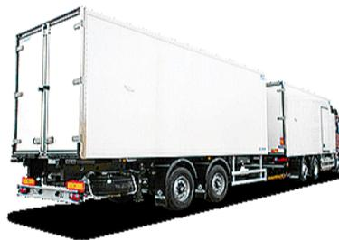
**Características:** Remolque sobre chasis específico de dos ejes y conjunto camión rígido+remolque homogéneos y compatibles. Integración del grupo en la cara delantera, en cámara o en el chasis. Distribución personalizable: remolques de dos frentes, multicompartmentos, puerta lateral, etc... Distribuciones estudiadas bajo solicitud: remolque de dos frentes, apertura total delantera y trasera, compuerta...
