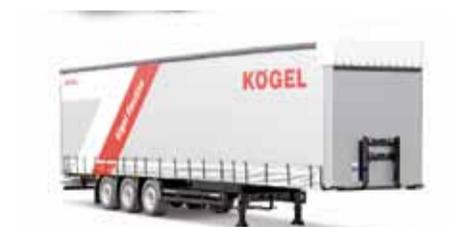
**Características:** Pueden usarse vehículos tractores con diferentes alturas de acoplamiento de enganche gracias al chasis especial. Al mismo tiempo, el FlexiUse puede adaptarse a estas alturas de acoplamiento de enganche gracias a carrocería ajustable en altura.
