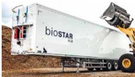
**Características:** Piso móvil con bastidor de aluminio o acero y caja de aluminio, para el transporte de biomasa, madera, papel, productos agrarios, palets, abonos... Marco posterior reforzado para carretillas elevadoras.
