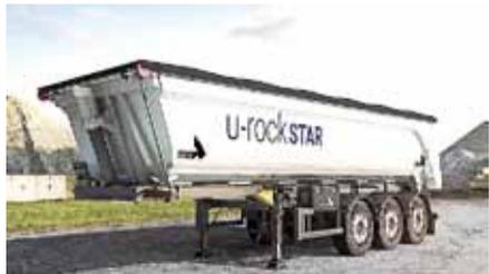
**Características:** Basculante con bastidor y caja de acero para transporte de piedras grandes y demoliciones... Eje de volteo integrado en el chasis y anchura del bastidor de 1.400 mm.
