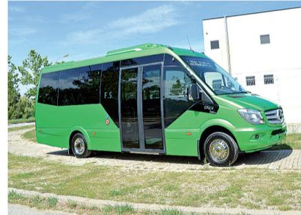
**Chasis:** Sobre chasis-cabina extralargo Mercedes-Benz Sprinter.
