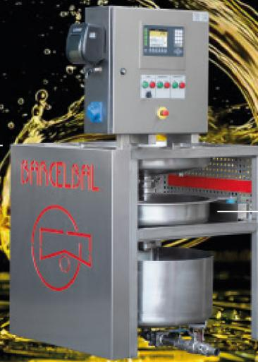
Depósitos cilíndricos con efecto centrífugo, reduciendo la espuma durante el pesaje del aceite de oliva
